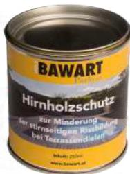
Ein Abschrägen der Schnittkanten der Stirnenden verhindert die Spreißelbildung und verbessert das Erscheinungsbild. Frisch geschnittene Stirnenden benötigen zudem einen Schutz durch den Auftrag des Hirnholzschutzes. Durch das Verwenden von Hirnholzschutz wird das schnelle Austrocknen bzw. Anfeuchten der Stirnseite des Holzes verhindert, was Rissbildungen deutlich vermindert.
