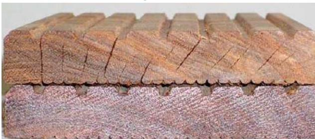
Der Hirnholzschutz kann auf allen handelsüblichen Holzarten angewendet werden. Er wird auf Basis von Naturwachsen hergestellt. Das Wachs hinterlässt eine matte, leicht weißliche, stumpfe Schicht, die kein Öl oder Farbe annimmt. Somit ist der Hirnholzschutz nicht für einen Anstrich auf der Lauffläche geeignet.
