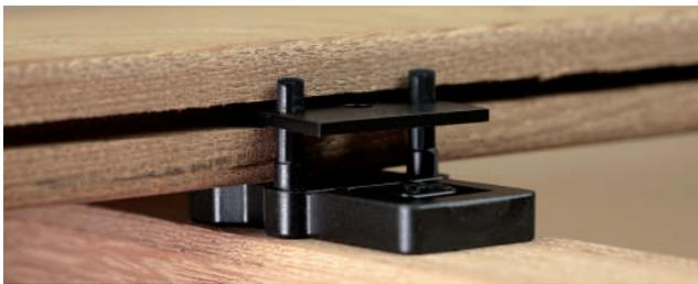
Das Terrassen-Verbindersystem LIGO S ist für die Montage von unseren seitlich genuteten Terrassendielen geeignet und dient zeitgleich als Distanzhalter für optimale Ventilation. Dieses Befestigungssystem ist bei Terrassendielen bis zu einer Länge von 3m freigegeben. Der Fugenabstand der Dielen beträgt dabei ca. 6mm. Die Nutplatte des LIGO S ist aus rostfreiem Edelstahl mit schwarzer Oberflächenbeschichtung, der Distanzhalter ist aus schwarzem Kunststoff.
