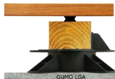
Beim Einsatz der Justierfüße oder Gummiunterlagen auf Dachabdichtungen bitte um zwingende Rücksprache mit dem ausführenden Spengler bzgl. Weichmacher und Materialverträglichkeit. Verwenden Sie z.B. das GUMO LGA mit der Alukaschierung für den Schutz gegen Weichmacher. Für etwaige Folgeschäden können wir nicht haften.
